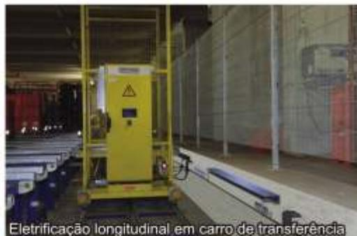
Eletificação longitudinal em carro de transferência
